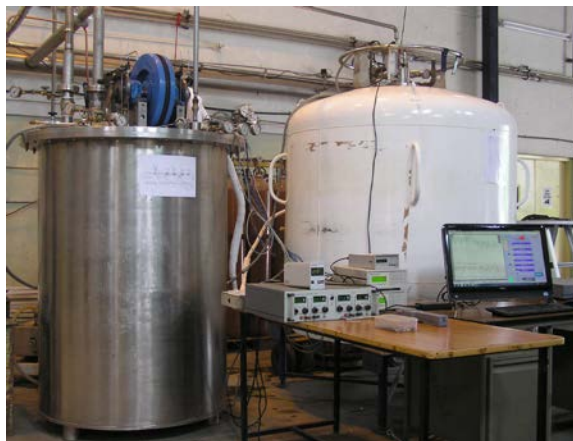
चित्र - 18 : स्वदेशी रूप से निर्मित 35 लीटर/घंटा क्षमता का हीलियम द्रावित्र
