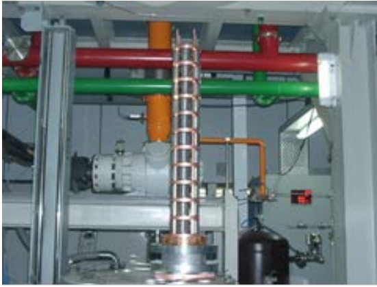
चित्र - 25 : अवरक्त मुक्त इलेक्ट्रॉन लेसर के लिए प्लेन वेव ट्रांसफार्मर लिनेक।
