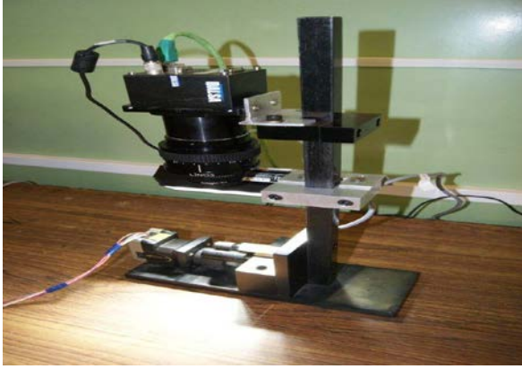
चित्र- 52 : ईंधन पैलेट के निरीक्षण हेतु लाइन कैमरा प्रणाली ।
