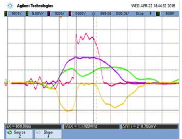
चित्र-5 : 20 MeV ऊर्जा पर नये माइक्रोट्रोन की 22 वीं कक्षा में बीम करंट वेवफार्म (बीम एक्स्ट्रैक्शन कक्षा) बीम करंट गुलाबी ट्रेस में दर्शाया गया है। (स्केल प्रत्येक प्रमाण =10 mA)
