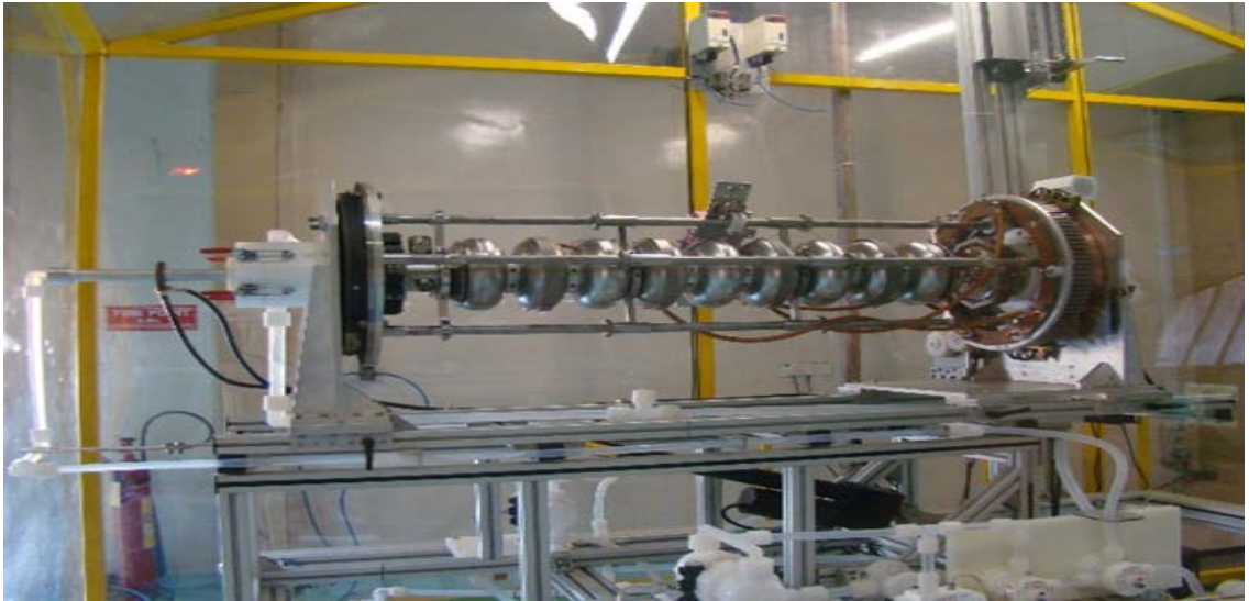
चित्र-14 : नौ सेल 1.3 GHz अतिचालक रेडियो आवृत्ति गुहिका का इलेक्ट्रोपोलिशिंग।
