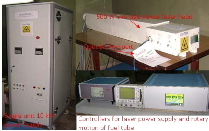
चित्र - 31 : IGCAR के लिए 10 kW पीक पावर फायबर युग्मिक स्पंदित एनडी:याग लेसर।
