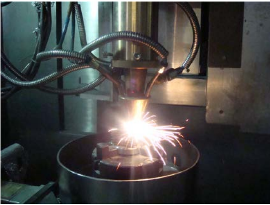
चित्र - 50 : लेसर योज्य निर्माण प्रक्रिया (LAM)।
