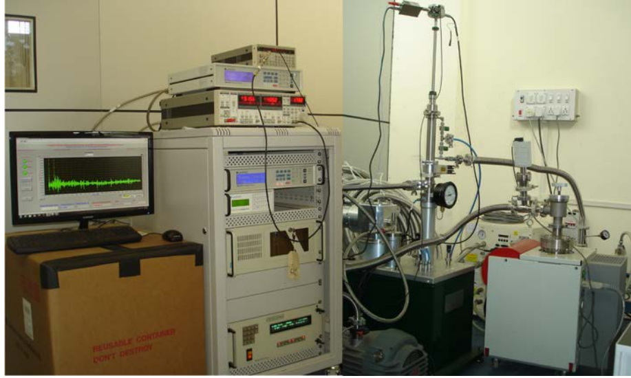
चित्र-62 : निम्न तापमान (2-300K) व उच्च मेगनेटिक फील्ड (70 kOe) पर इलास्टिक स्थिर पदार्थ के मापन की रिजोनेंट पराध्वनि स्पेक्ट्रोस्कोपी की प्रायोगिक सुविधा।
