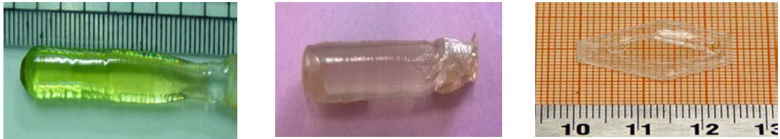
चित्र - 59 : विभिन्न तकनीकों का इस्तेमाल कर कुछ उच्च प्रकाशिक गुणवत्ता वाले क्रिस्टलों के वर्धन संबंधी चित्र। (a) Cr-Co-doped YVO_4 (b) Sr_{0.61}.Ba_{0.39}Nb_2O_6 (SBN), (c) ट्रांस स्टीलबिन।
