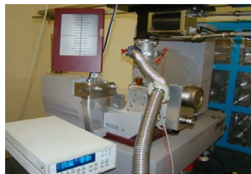
चित्र-7 : कोण परिक्षेपी एक्सरे विवर्तन (ADXRD) बीमलाइन (BL-12) की इमेज प्लेट पर संस्थापित संवृत चक्र क्रायोस्टेट आधारित सेम्पल कूलिंग।
