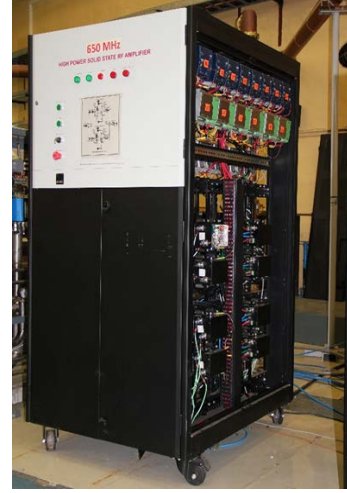
चित्र- 64 : भारतीय संस्थान फर्मीलेब सहयोग के तहत विकसित 30 kW-650 MHz ठोस अवस्था प्रवर्धक।
