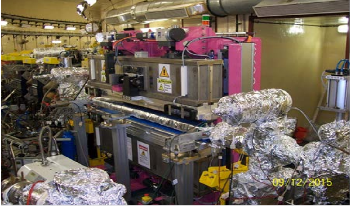
चित्र-2: निर्वात कक्ष एवं अन्य उपकरणों के साथ LS-5 में एपल-2 तरंगक की स्थापना ।
