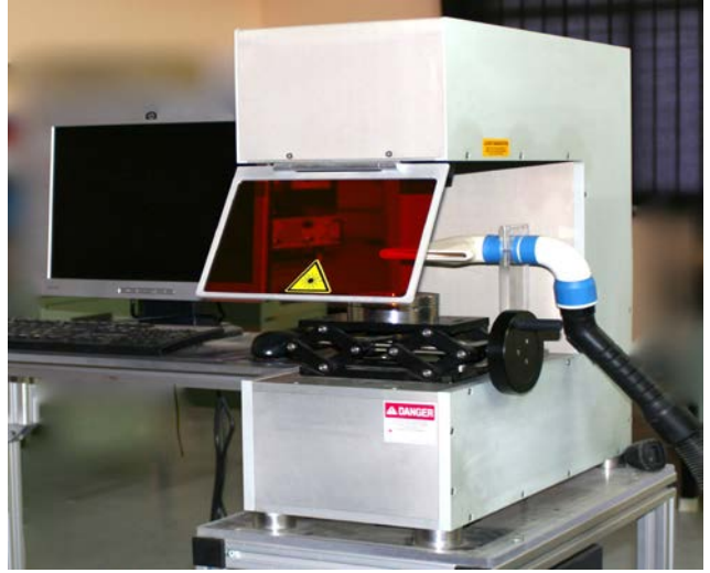
चित्र-58 : विकसित फायबर लेसर माइक्रो मशीनिंग का चित्र ।
