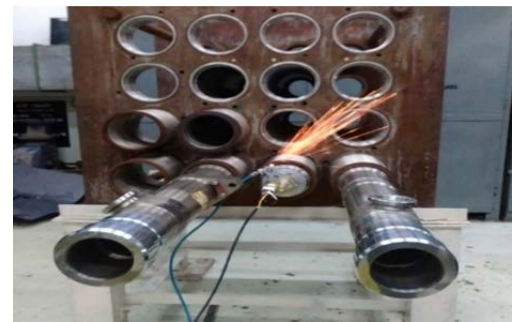
चित्र - 44 : प्रेशर ट्यूब स्टब के जलमग्न लेसर कटिंग हेतु औजार का चित्र (b) आउटबोर्ड End फिटिंग के बाद बेलो लिप का लेसर कटिंग मॉक अप।
