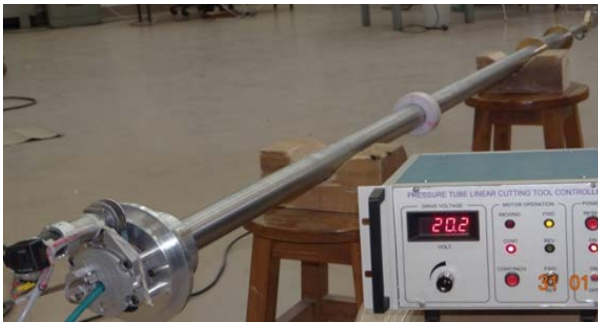
चित्र - 44 : प्रेशर ट्यूब स्टब के जलमग्न लेसर कटिंग हेतु औजार का चित्र (b) आउटबोर्ड End फिटिंग के बाद बेलो लिप का लेसर कटिंग मॉक अप।
