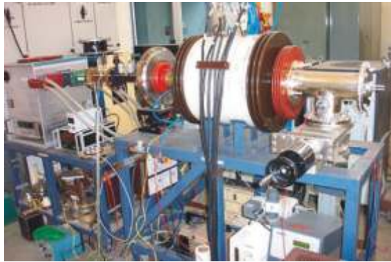
Fig. A.5.1 ECR proton source
