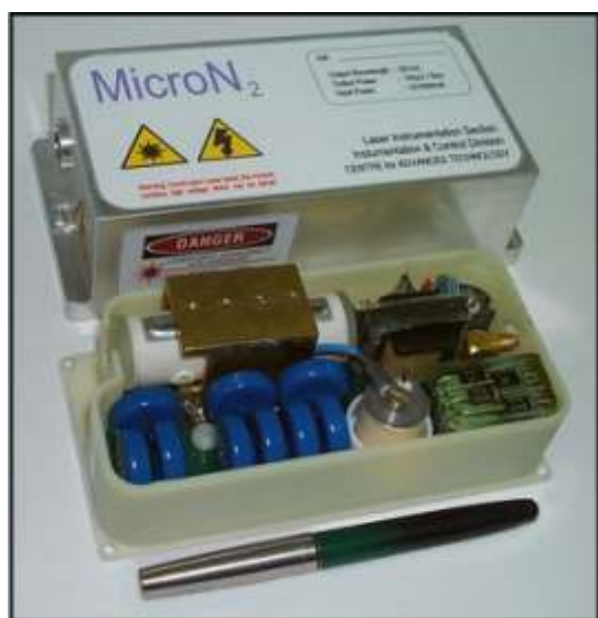
Fig.T.1. 2: Miniature nitrogen laser system.
